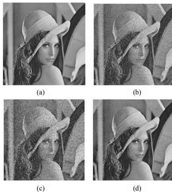
図 2:(a)Lenna の原画像 (b)インパルスノイズ( p=0.2 ) (c)ごま塩ノイズ( p=0.2 ) (d)ガウシアンノイズ( \sigma=20 )[7]
